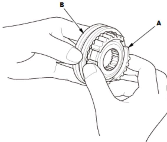
1. 检查所有同步轮毂和同步轴套上的齿轮轮齿是否磨损（尖角磨圆）。
